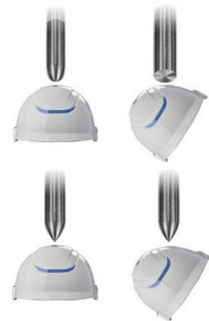
De EN 12492 helmen worden getestaan zowel bovenkant als zijkant op schok- en penetratiebestendigheid
