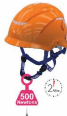
De EN 12492 kinband moet een kracht van 500 Newton 2 minuten weerstaan
